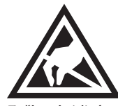
Zařízení citlivé na elektrostatický náboj
