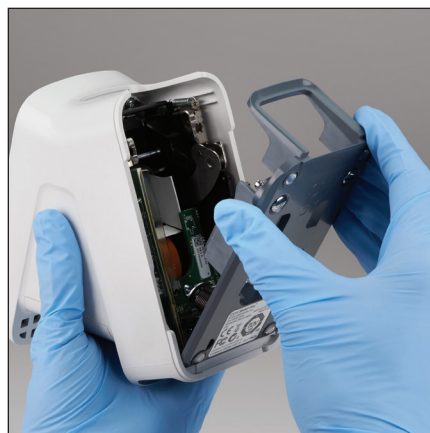
6. Po vysušení základnu připojte zpět k analyzátoru a ujistěte se, že zaklapla na místo.
